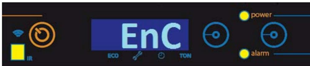
Una vez terminado el proceso de encendido con éxito, en el display aparecerá la palabra "En.C", lo cual indica que el sistema ha terminado con éxito el encendido. A continuación con la pulsación del botón repetidas veces accedemos a modo Manual o Automático.
