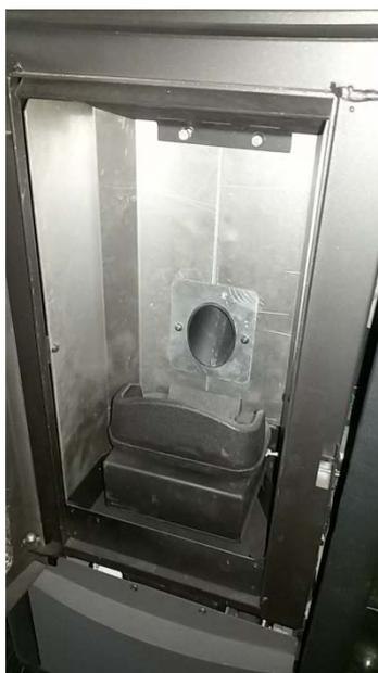
Un simple control visual, efectuado diariamente, permite controlar la eficiencia y limpieza del brasero. Para una limpieza eficaz del brasero, extraerlo completamente de su base y limpiar a fondo todos los agujeros.
