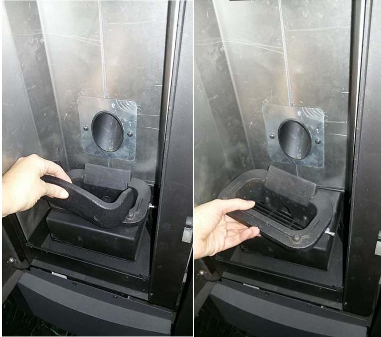
Retire el **brasero**<sup>1</sup> y elimine los restos no quemados que hayan podido quedar depositados sobre él. Normalmente utilizando un pellet de buena calidad es suficiente el empleo de un pincel para limpiarlo. Con combustible de mayor generación de cenizas y suciedad será necesario un cepillo e incluso un pequeño punzón para introducir por los agujeros obstruidos.
