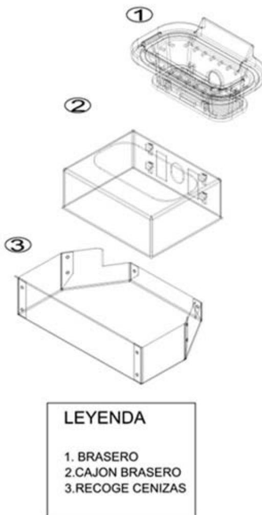
1. Retire el brasero y elimine los restos no quemados que hayan podido quedar depositados sobre él.
