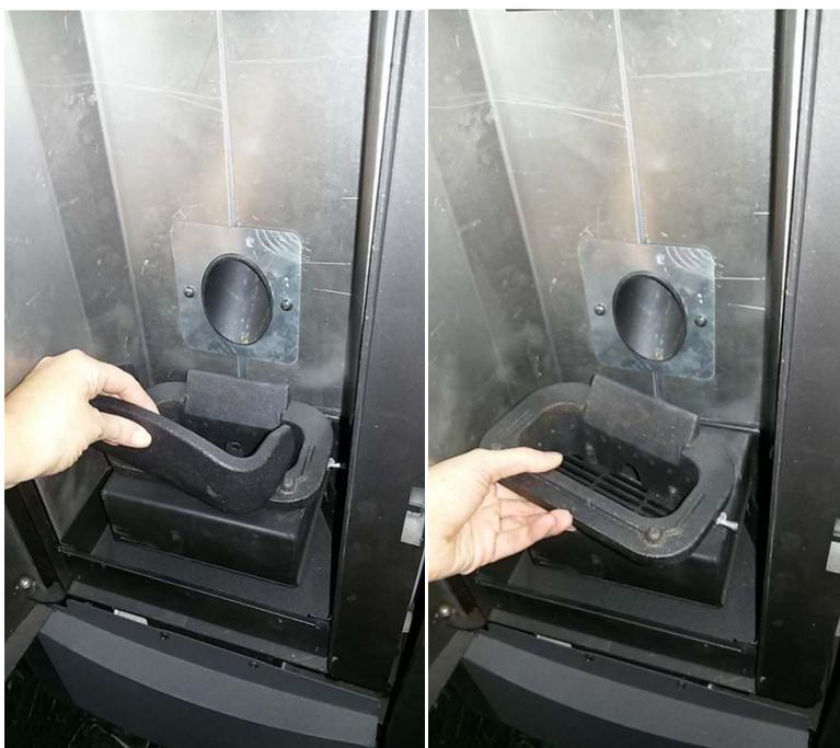
Normalmente utilizando un pellet de buena calidad es suficiente el empleo de un pincel para limpiarlo. Con combustible de mayor generación de cenizas y suciedad será necesario un cepillo e incluso un pequeño punzón para introducir por los agujeros obstruidos.
